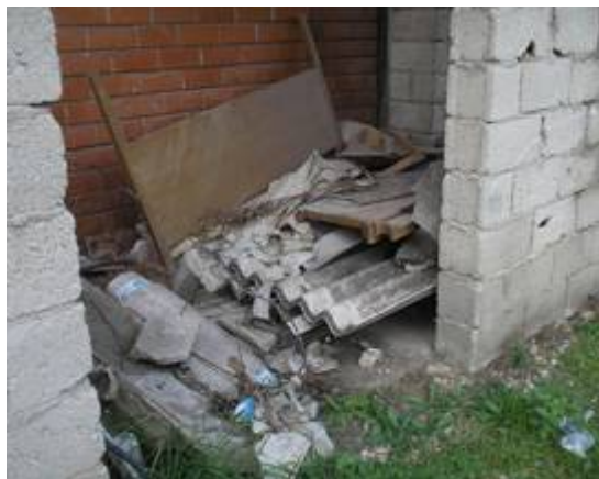
L'AQUILA - Eternit nel nucleo industriale di Bazzano (L'Aquila).
